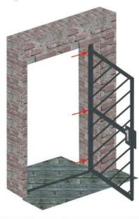
Montagelöcher auf Türgitterbandseite bohren
