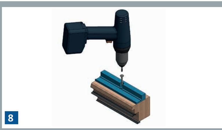
**8** Die Aufnahmeleiste VITRUM SINE EASY auf dem Fensterprofil ausrichten und mit der Montageschraube befestigen.
