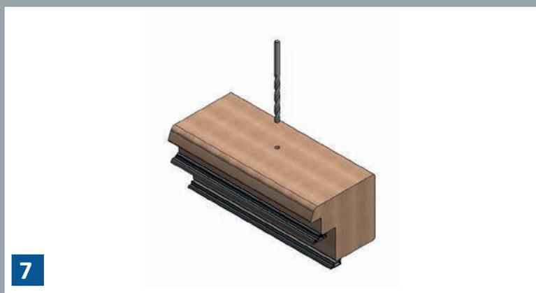
**7** Den Blendrahmen oder Pfosten mit einem Bohrer vorbohren
